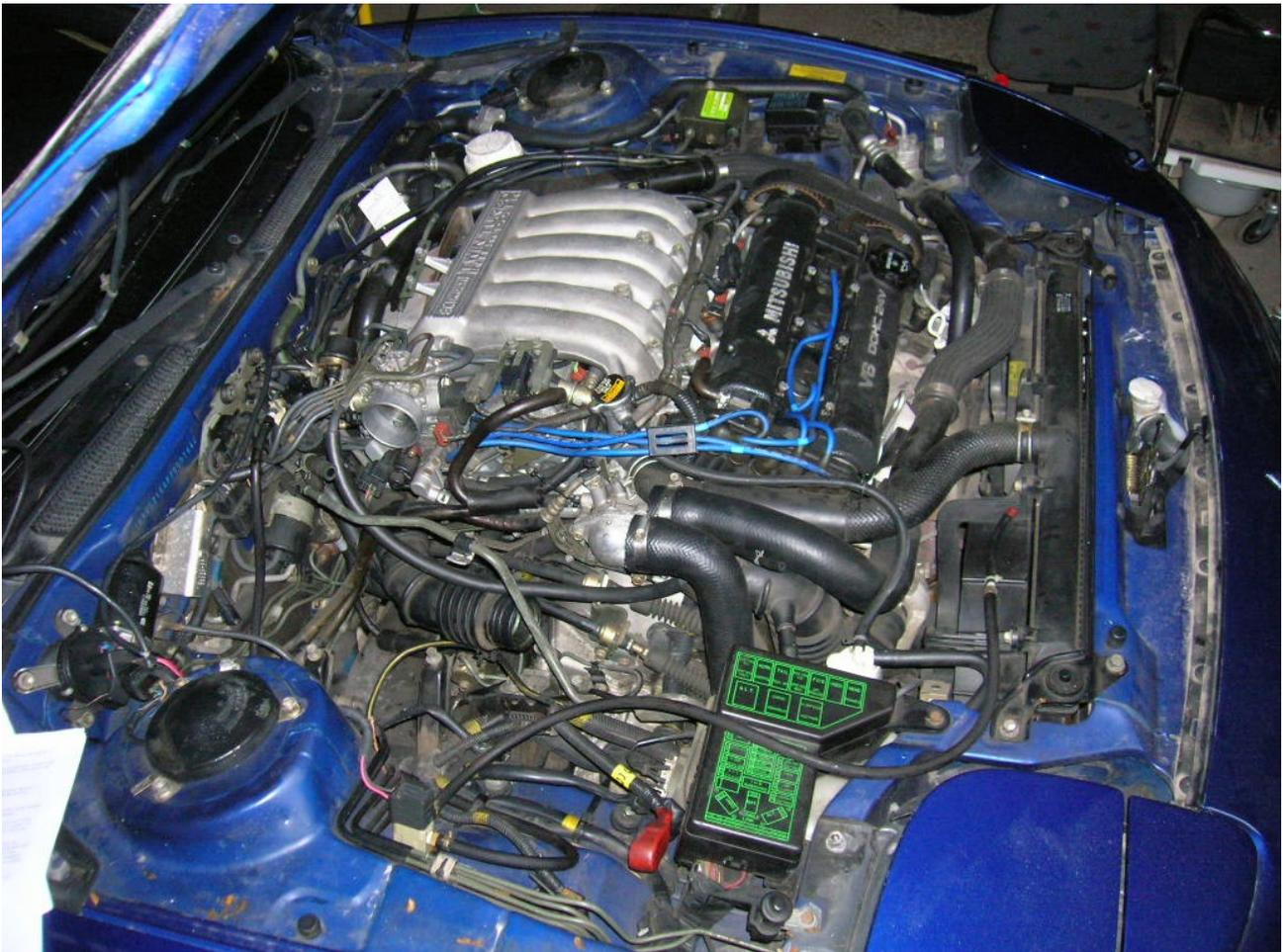
*Entfernter Ansaugtrakt, Batterie, Wischwassertank, Y-Pipe und LLK Schläuche*
