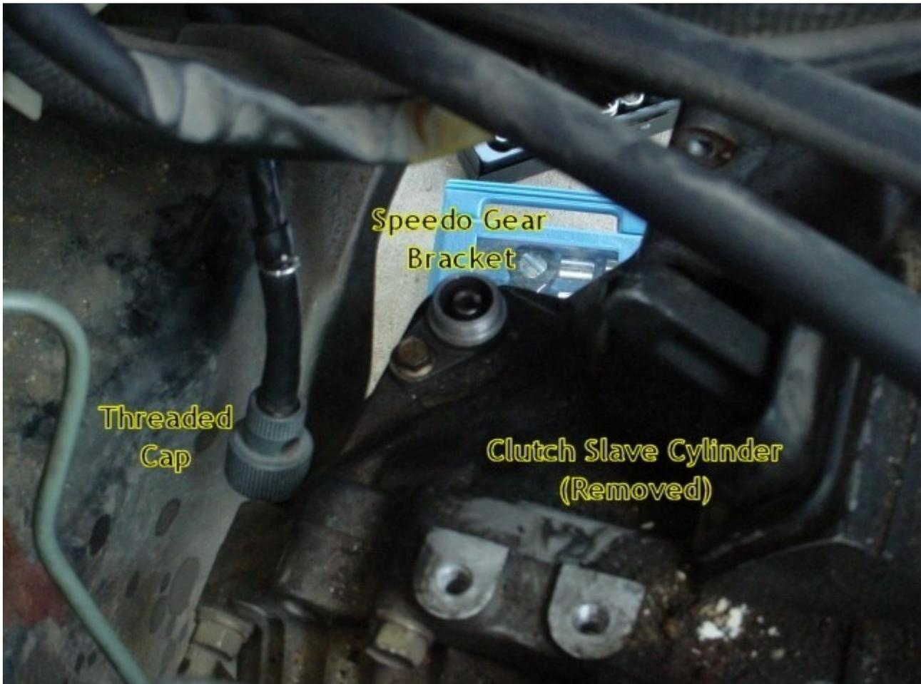
*Threaded Cap: geriffelte Hülse; Speedo Gear Bracket: Geschwindigkeitsgeber; Clutch Slave Cylinder (removed): Montagepunkt für den Kupplungsnehmerzylinder*
