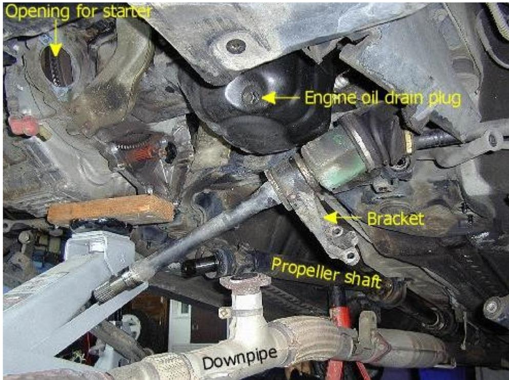
*Opening for Starter: Öffnung für den Anlasser; Engine Oil drain plug: Motoröl Ablassschraube; Bracket: Achshalter; Propeller Shaft: Kardanwelle*
